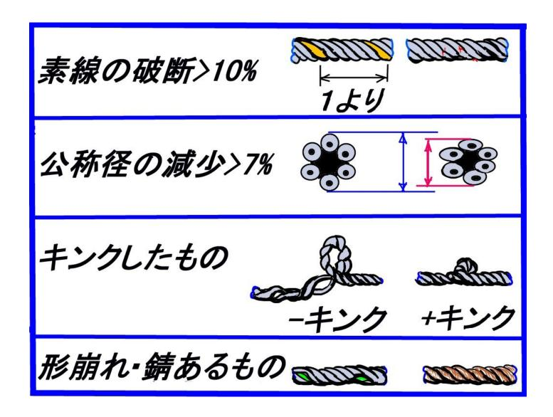
点検事項は、①:**断線・**②:**摩耗・**③:**キンク・腐食・**④;**型崩れ**等について行い、どれか一つでも使用禁止基準に達していれば、そのワイヤロープは使用してはならない。
